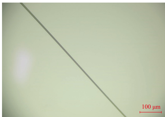
图 2 拉锥后的高非线性光纤显微图
