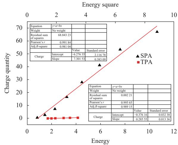
图 7 单光子(双光子)电荷量与能量(能量平方)线性关系拟合图
