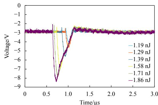
图 5  $1200$  nm 脉冲激光能量变化对 LM741 CH 运算放大器响应电压的影响
