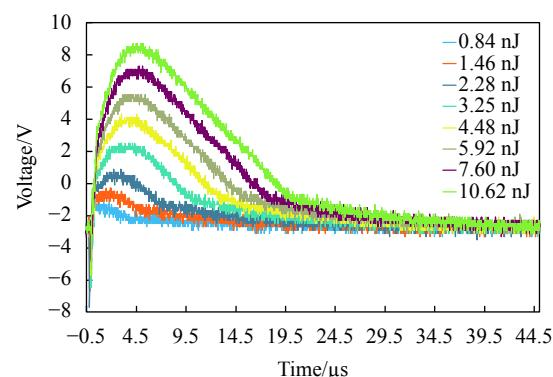
图 4  $1064$  nm 脉冲激光能量变化对 LM741 CH 运算放大器响应电压的影响
