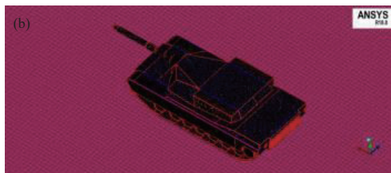
图 12 (a) 带内热源的模型坦克目标的几何模型示意图; (b) 带内热源的模型坦克目标的网格划分示意图
